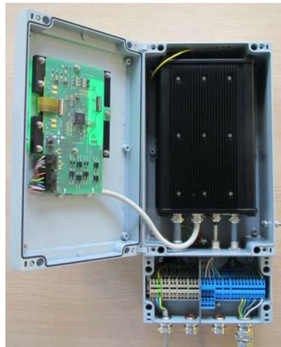
Ouverture du boîtier en zone à risque ATEX pour un paramétrage facile (le remplacement de câbles nécessite de couper l'alimentation)
