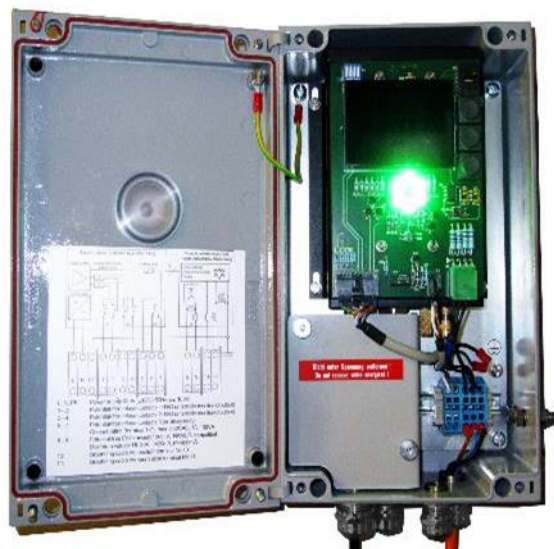
Рис. 3: Настройка устройства контроля заземления во взрывоопасных зонах при открытом корпусе и подаче напряжения
