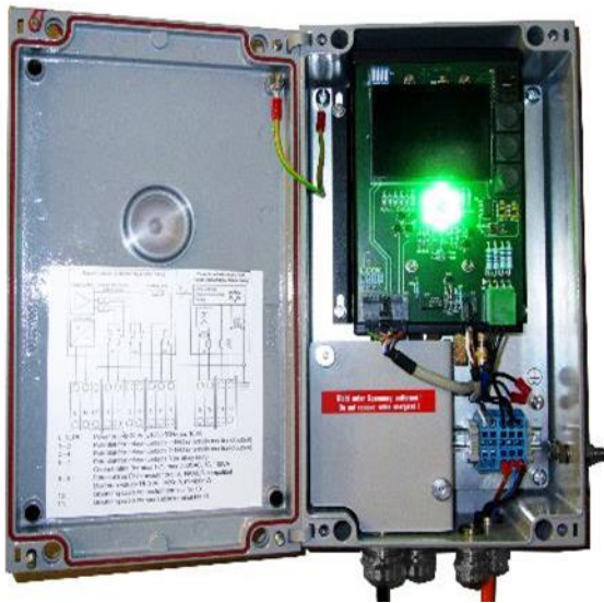
Abb. 3: Konfiguration des Erdungstestgeräts in gasexplosionsgefährdeten Bereichen mit geöffnetem Gehäuse und unter Spannungsversorgung
